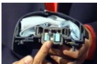
Der Fahrerairbag – in der Mitte der blaugrüne Treibstoff
