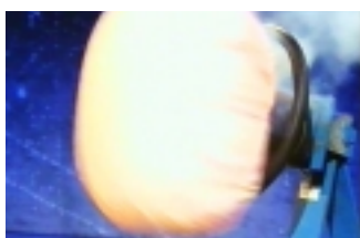
In 30 Millisekunden ist der Airbag aufgeblasen
