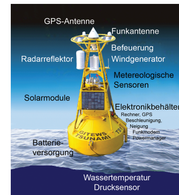
Schematischer Aufbau der GPS-Boje
