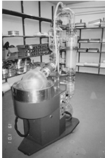
Zur Destillation. Rotationsverdampfer, der zur Herstellung von Haschischöl verwendet werden kann. FOTO POLIZEI
