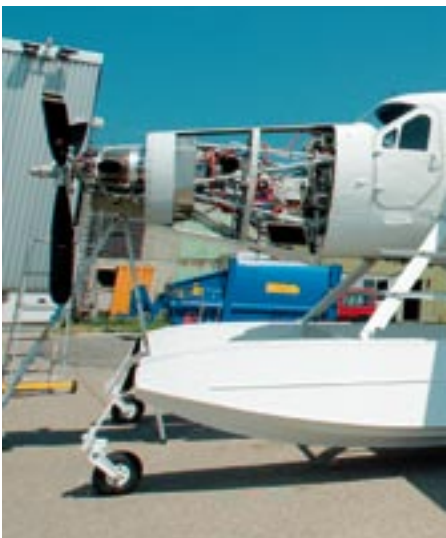
Die PT6A-34 Turbine leistet 750 PS.
