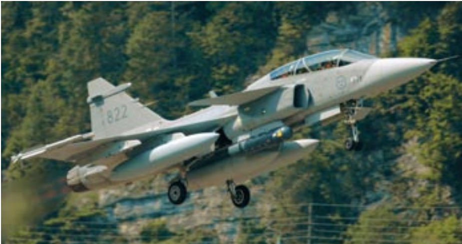
Schwer beladen mit drei Zusatztanks, einem Laser-Designator-Pod und zwei IRIS-T-Infrarotlenk-waffen startet der Saab Gripen in Meiringen zu einem weiteren Testflug.
