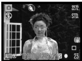
Drücken Sie den Auslöser leicht an. Das AF-System wird das Motiv finden und die digitale Motivprogrammwahl wählt ein Programm. Wird kein Symbol eingeblendet, ist die Belichtungsautomatik aktiv. Drücken Sie den Auslöser ganz durch, um das Bild aufzunehmen. Halten Sie die Kamera ruhig, wenn das Programm „Sonnenuntergang“ ausgewählt ist, denn die Verschlusszeit kann hierbei lang sein.
