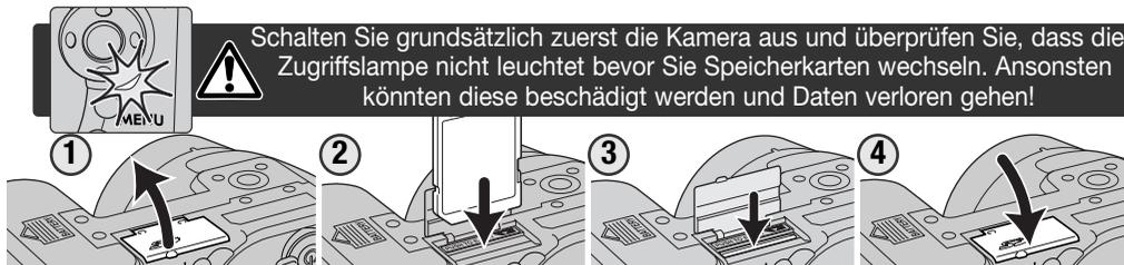
1. Öffnen Sie die Kartenschachtklappe an der Unterseite der Kamera.
