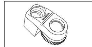
Es un receptor de luz reflejada con un ángulo de aceptación de 5°. La instalación del AUTO METER VF en lugar del Difusor Esférico, el medidor puede hacer mediciones en un punto. Se utiliza un índice de corrección de acercamiento para mediciones de objetos a distancia de aprox. 1 m.
