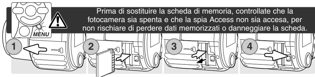
1. Aprite il coperchio dello slot di alloggiamento della scheda, facendolo scorrere verso lato anteriore della fotocamera.
