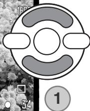
Usate i tasti alto/basso del "joystick" (1) per impostare l'apertura di diaframma. Il valore di apertura si modifica con incrementi di 1/3 stop. Premete parzialmente il pulsante di scatto per attivare il sistema esposimetrico: sullo schermo LCD compare il tempo di scatto più adatto.
