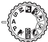
Su A, voi selezionate l'apertura di diaframma e la fotocamera imposta automaticamente il tempo di scatto necessario per una corretta esposizione. Selezionando la priorità al diaframma, l'indicazione del valore di apertura sullo schermo LCD si colora di blu ed è affiancata da una doppia freccia. Se volete usare il flash impostatelo sull'attivazione forzata o sull'attivazione forzata con funzione anti-occhi rossi oppure sulla sincronizzazione con tempi lunghi (p. 26).
