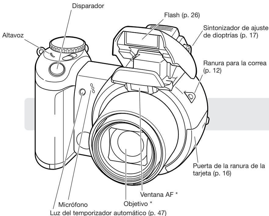
El puerto USB y la terminal de salida AV están situados detrás de la puerta de la ranura para la tarjeta. La puerta del compartimento de las pilas (p. 13) y la toma para el trípode están situadas en la parte inferior del cuerpo.
