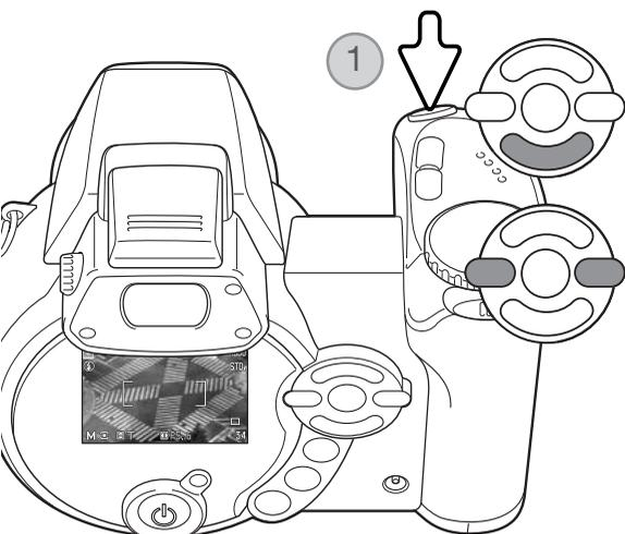
Use la tecla de abajo del controlador para disminuir la velocidad del obturador por debajo de 15 segundos, hasta que aparece la letra “T”.
