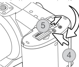
Cierre la puerta del compartimento de pilas y deslícela hacia el cuerpo (4) para enganchar el pestillo de seguridad. Deslice el cierre del compartimento de las pilas hacia la posición de cerrado (5).
