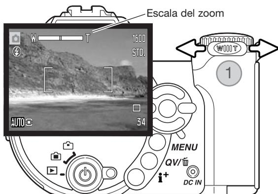
La palanca del zoom controla el objetivo (1). Deslizando la palanca hacia la derecha (T) el zoom se situará en la posición de teleobjetivo. Deslizando la palanca hacia la izquierda (W) el zoom cambiará a la posición de gran angular.
