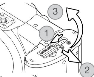
Para abrir la puerta del compartimento de las pilas, deslice el cierre a la posición de abierto (1). Deslice la puerta hacia el lateral de la cámara (2) para soltar el pestillo de seguridad. Levante la puerta para abrirla (3).
