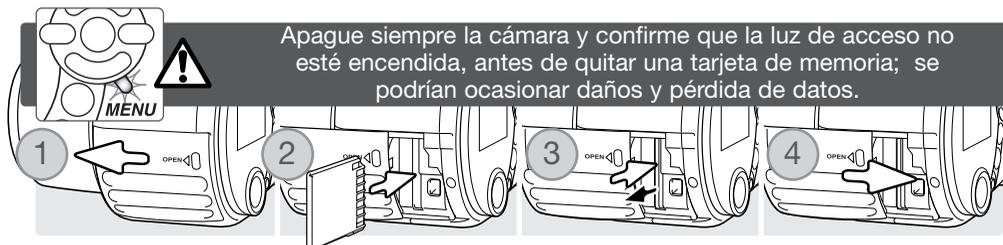
1. Abra la puerta de la ranura para la tarjeta deslizándola hacia la parte delantera de la cámara.
