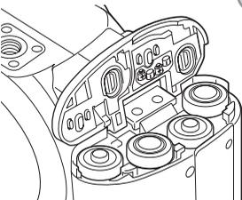
Inserte las pilas como se indica en el diagrama que hay en el interior de la puerta del compartimento de las pilas. Confirme que los polos positivo y negativo de las pilas están orientados correctamente.
