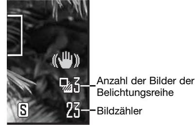
Auf dem Monitor wird neben dem Belichtungsreihensymbol die verbleibende Bildanzahl angezeigt. Falls auf der Speicherkarte kein Platz mehr frei ist oder der Auslöser losgelassen wird, bevor die Serienbildaufnahme komplett ist, bricht der Vorgang ab, und die gesamte Belichtungsreihe muss wiederholt werden. Der Blitz kann zur Erstellung einer Belichtungsreihe nicht verwendet werden.
