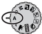
Der Fotograf wählt die gewünschte Blende vor, und die Zeitautomatik stellt die passende Verschlusszeit für die korrekte Belichtung ein. Wenn die Zeitautomatik aktiv ist, leuchtet die Blendenzahl in der Anzeige blau und ein Doppelpfeil wird daneben angezeigt. Sie können zum Blitzen die Blitzfunktionen „Aufhellblitz“, „Aufhellblitz mit Verringerung des „Rote-Augen-Effekts“ sowie „Langzeitsynchronisation mit Verringerung des „Rote-Augen-Effekts“ verwenden (S. 26).
