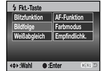
Drücken Sie zum Ändern der Einstellung der im Menü festgelegten Funktion die Funktionstaste. Zum Übernehmen der geänderten Einstellung drücken Sie die mittlere Steuertaste oder den Auslöser einmal leicht an.
