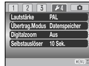
Zum Wechsel des Videoausgangs zwischen NTSC und PAL (S. 98).
