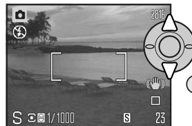
Stellen Sie mit der oberen/unteren Steuertaste (1) die gewünschte Verschlusszeit ein. Drücken Sie den Auslöser leicht an, um das Belichtungsmesssystem zu aktivieren; der jeweilige Blendenwert wird auf dem Monitor angezeigt.
