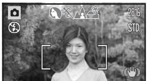
Platzieren Sie das Motiv innerhalb des AF-Rahmens. Achten Sie darauf, dass sich das Motiv innerhalb des Scharfeinstellungsbereiches befindet (S. 24). Verwenden Sie für sehr kleine Motivabstände die Makrofunktion (S. 35).
