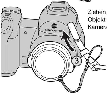
Ziehen Sie dann den Umhängeriemern durch die Schlaufe des Objektivdeckelriemens und dann durch die Riemenöse an der Kameragehäuse (3).
