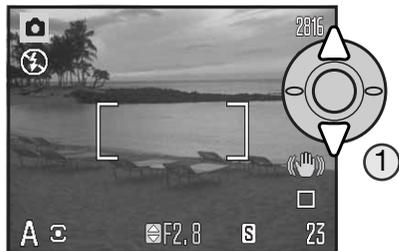
Stellen Sie mit der oberen/unteren Steuertaste (1) die gewünschte Blende ein. Sie kann in 1/3 Blendenstufen eingestellt werden. Drücken Sie den Auslöser leicht an, um das Belichtungsmesssystem zu aktivieren; die jeweilige Verschlusszeit wird auf dem Monitor angezeigt.
