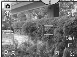
Führen Sie die Bildkomposition wie in den Grundlagen der Aufnahme beschrieben durch; drücken Sie den Auslöser leicht an (1), um die Belichtungswerte und die Scharfeinstellung einzustellen und zu fixieren. Drücken Sie den Auslöser ganz durch, um das Bild aufzunehmen.
