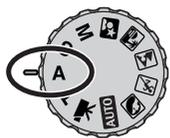
El fotógrafo selecciona la apertura y la cámara fija la velocidad del obturador apropiada para asegurar la exposición correcta. Cuando se selecciona la prioridad de apertura, el valor de apertura en el monitor se vuelve de color azul y aparece un indicador con una flecha doble a su lado. El modo de flash se puede establecer en flash de relleno, flash de relleno con reducción de ojos rojos o sincronización lenta con reducción de ojos rojos (p. 26).
