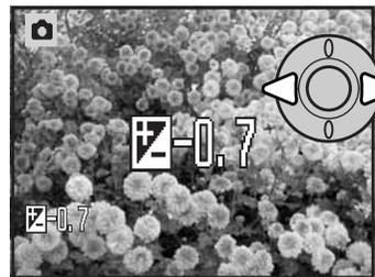
Para ajustar la exposición, presione la tecla derecha o la tecla izquierda del controlador; aparece la pantalla de compensación de exposición.
