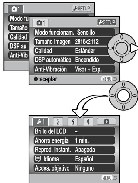
Use la tecla derecha del controlador para seleccionar la pestaña de Configuración situada en la parte superior del menú.
