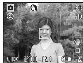
Presione el disparador hasta la mitad. El sistema AF localiza el objeto y la función de Selección de Objeto Digital Automática escogerá un programa objeto. Si no apareciera ningún indicador, significa que está activada la exposición automática programada. Presione el disparador hasta abajo para sacar la fotografía. Sujete la cámara con firmeza cuando esté seleccionado el programas objeto de Puesta de Sol, ya que las exposiciones pueden ser largas.
