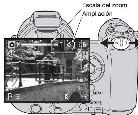
El zoom digital funciona mediante la palanca del zoom (1). Deslice la palanca hacia la derecha (T) para poner el zoom en la posición de teleobjetivo. Cuando el zoom digital se activa, la ampliación de la imagen se visualiza en el monitor. Poniendo la palanca hacia la izquierda (W) se quitará el zoom de esta posición. Después de usar el zoom, aparece brevemente la escala del zoom. La sección amarilla indica el rango del zoom digital.
