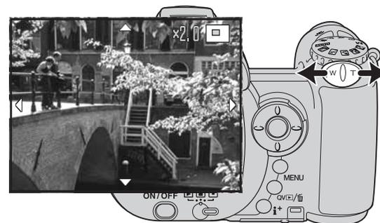
Con la imagen que se desea ampliar visualizada, deslice la palanca del zoom hacia la derecha (T) para activar el modo de reproducción ampliada. El grado de ampliación aparece en el monitor LCD.
