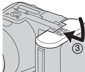
Cierre la puerta del compartimento de pilas y deslícela hacia el cuerpo (3) para enganchar el pestillo de seguridad.
