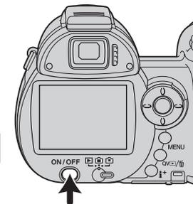
El interruptor de modo, que está junto al interruptor principal, se utiliza para cambiar entre los modos de Grabación y Reproducción, así como seleccionar entre la visualización en el monitor y en el visor.
