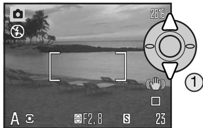
Use las teclas de arriba / abajo del controlador (1) para fijar la apertura. El valor de apertura se puede cambiar en incrementos de 1/3 de parada. Presione el disparador hasta la mitad para activar el sistema de exposición; en el monitor aparecerá su correspondiente velocidad de obturador.
