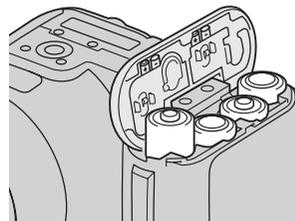
Inserte las pilas como se indica en el diagrama que hay en el interior de la puerta del compartimento de las pilas. Confirme que los polos positivo y negativo de las pilas están orientados correctamente.
