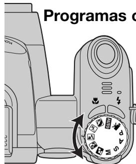
Los programas objeto digitales optimizan la exposición de la cámara, el balance de blancos y los sistemas de proceso de imagen para condiciones y objetos específicos. Simplemente mueva el sintonizador del modo de exposición para seleccionar el programa objeto adecuado; el programa objeto activado aparecerá en la esquina inferior izquierda del monitor.
