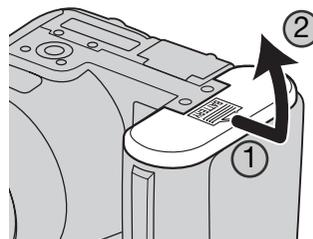
Para abrir la puerta del compartimento de las pilas, deslice la puerta hacia un lado de la cámara (1) para soltar el pestillo de seguridad. Levante la puerta para abrirla (2).
