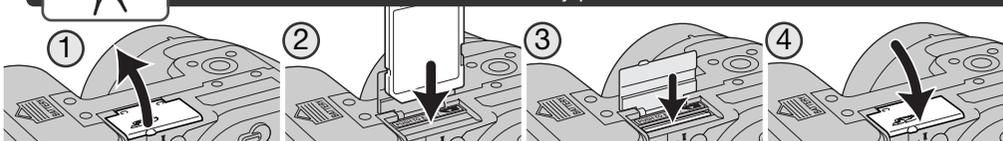
1. Abra la puerta de la ranura para la tarjeta situada en la parte inferior de la cámara.
