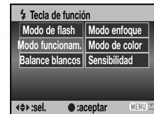
Presionando el botón de modo de flash se establece la función en el menú. Presione el botón central del controlador o bien presione el disparador hasta la mitad, para aplicar la configuración.
