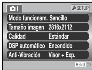
El sistema Anti-Vibración es menos efectivo en distancias cortas respecto al objeto, o cuando se emplea la función Macro (p. 35). Se recomienda utilizar un trípode. La Anti-Vibración no es efectiva con la cámara montada en un trípode; apague la función de Anti-Vibración para conservar la energía.
