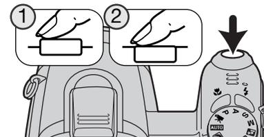
Ya que el enfoque y la exposición se determinan cuando se presiona el disparador, no se coloque frente a la cámara cuando haga fotos con el temporizador automático. Confirme siempre el enfoque con las señales de enfoque antes de comenzar la cuenta atrás (p. 25).
