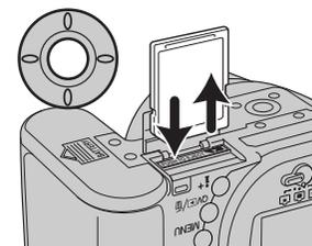
Cuando aparece el mensaje de “Cambiar Tarjeta”, quite la tarjeta de memoria de la cámara e inserte la tarjeta a la que desea copiar la imagen. Presione el botón central del controlador para continuar, o bien el botón del menú para cancelar la operación de copiar.
