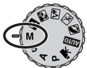
El modo de exposición manual permite la selección individual de velocidades de obturador y aperturas. Este modo no hace caso del sistema de exposición, proporcionando al fotógrafo un control total sobre la exposición final.
