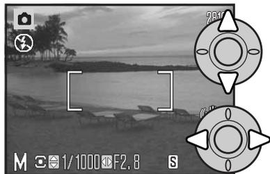
Use las teclas de arriba / abajo del controlador para modificar la velocidad del obturador.
