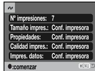
Una vez empieza la impresión, la operación se puede cancelar presionando el centro del controlador. Cuando finaliza la impresión, un mensaje indica el final de la operación; presione el centro del controlador y apague la cámara para terminar el proceso.
