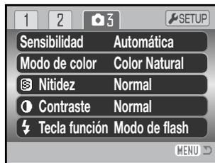
La configuración automática, ajusta de forma automática la sensibilidad de la cámara según las condiciones de iluminación, entre ISO 50 y 160. Cuando se establece cualquier otra configuración que no sea la automática, aparecerá la palabra "ISO" en el monitor junto con el valor establecido.
