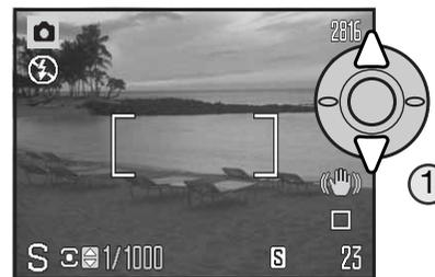
Use las teclas de arriba / abajo del controlador (1) para fijar la velocidad del obturador. Presione el disparador hasta la mitad para activar el sistema de exposición; aparecerá en el monitor la apertura correspondiente.
