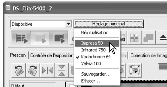
Pour réinitialiser le scanner à ses réglages initiaux, clique sur le bouton Réglage principal pour afficher le menu. Sélectionner l'option Réinitialiser pour terminer l'opération.
