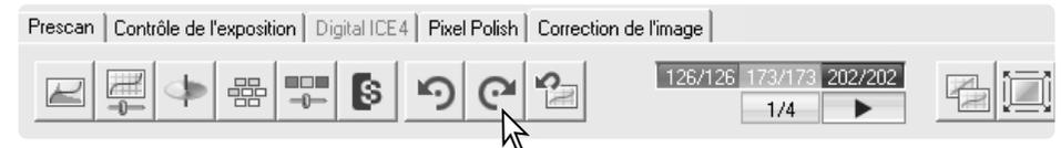
Les boutons annuler, rétablir et réinitialisation ne concernent que les outils utilisés pour les corrections d'image et n'ont aucun impact sur les fonctions de correction logiciel.
