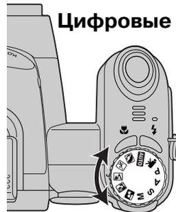
Цифровые сюжетные программы оптимизируют экспозицию, баланс белого и систему обработки изображений для съемки определенного типа объектов в определенных условиях освещения. Для выбора нужной сюжетной программы нужно повернуть переключатель режимов экспозиции. Индикатор активной сюжетной программы отображается в нижнем левом углу ЖК-дисплея.
