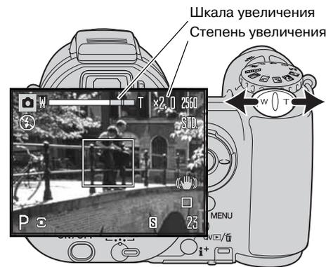
Управление цифровым зумом осуществляется при помощи рычажка (1). Подвиньте рычажок вправо (T), чтобы перевести объект в телеположение. Если включена функция цифрового зума, в верхней части экрана будет отображена степень увеличения. Подвиньте рычажок зума влево (W), чтобы уменьшить эффект зума. После работы с зумом ненадолго отображается шкала увеличения. Желтая часть шкалы отображает диапазон цифрового зума.
