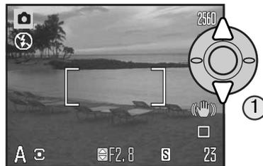
При помощи кнопок контроллера “вверх” / “вниз” (1) установите диафрагму. Значение диафрагмы можно изменять шагами по 1/3 Ev. Для активации экспозиционной системы камеры прижмите кнопку спуска затвора наполовину. Соответствующее значение выдержки будет отображено на дисплее.
