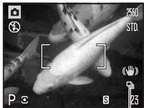
Режимы "протяжки" управляют скоростью и методом съемки. Нужный режим "протяжки" можно установить в любом из меню, за исключением меню съемки видео. В режимах автоматической съемки или Цифровой Сюжетной Программы, режим протяжки устанавливается на покадровую при выключении камеры. В экспозиционных режимах P, A, S и M режим протяжки сохраняется, пока не изменится вручную. Далее рассматриваются различные режимы "протяжки".
