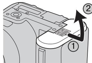
Чтобы открыть батарейный отсек, сдвиньте крышку батарейного отсека в сторону (1), сработает защелка. Поднимите крышку (2).
