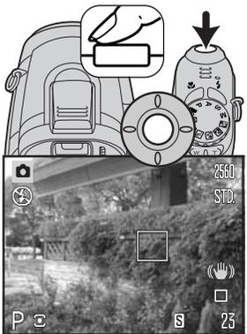
Прижмите наполовину кнопку спуска затвора или нажмите центральную кнопку контроллера, чтобы выбрать нужную зону. Остальные две зоны фокусировки пропадут. Только когда одна из зон фокусировки выбрана, контроллер может быть использован для управления другими функциями фотокамеры.
