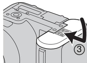
Закройте крышку батарейного отсека и сдвиньте ее по направлению к корпусу фотокамеры (3) для закрытия защелки крышки батарейного отсека.
