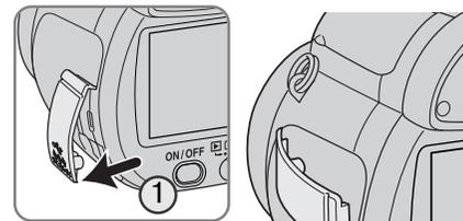
Откройте крышку гнезда сетевого адаптера (1) и вставьте штеккер адаптера в гнездо (2).
