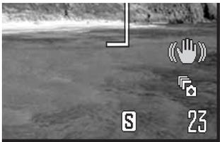
В режиме прогрессивной съемки фотокамера может снимать изображения до тех пор, пока удерживается нажатой кнопка спуска затвора. Когда кнопка спуска затвора отпущена, все изображения, которые содержатся в этот момент в буферной памяти камеры, сохраняются на карту памяти. Установить нужный режим можно в разделе 1 меню режима съемки.
