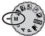
В режиме ручной установки экспозиции Вы можете самостоятельно устанавливать выдержку, и диафрагму. В данном режиме экспонометрическая система камеры отключается, предоставляя фотографу полный контроль окончательной установки экспозиции.
