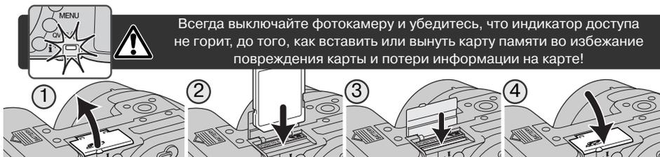
1. Откройте крышку отсека с картой, расположенного на нижней стороне фотокамеры.
