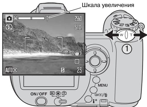
Зум объектив управляется рычажком (1). Нажатие рычажка вправо (T) переведет объектив в телефото положение. Нажатие рычажка влево (W) переведет объектив в широкоугольное положение.
