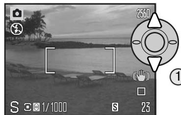
При помощи кнопок контроллера “вверх” / “вниз” (1) установите значение выдержки. Для активации экспозиционной системы камеры прижмите кнопку спуска затвора наполовину. Соответствующее значение диафрагмы будет отображено на дисплее.
