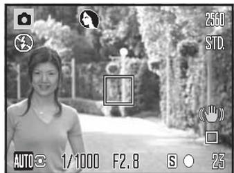
Sin levantar el dedo del disparador, recomponga el objeto dentro del área de la imagen. Presione el disparador hasta abajo para sacar la fotografía.
