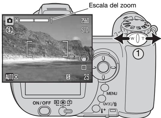
La palanca del zoom controla el objetivo (1). Deslizando la palanca hacia la derecha (T) el zoom se situará en la posición de teleobjetivo. Deslizando la palanca hacia la izquierda (W) el zoom cambiará a la posición de gran angular.
