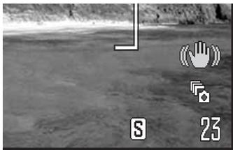
El modo de funcionamiento de Captura Progresiva graba imágenes continuamente mientras se mantiene presionado el disparador. Cuando se suelta el disparador, se guardan las imágenes almacenadas en la memoria intermedia de la cámara. Este modo de manejo se establece en la sección 1 del menú de Grabación.
