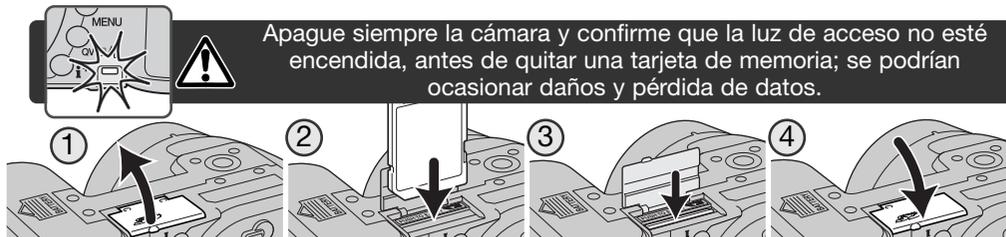
1. Abra la puerta de la ranura para la tarjeta situada en la parte inferior de la cámara.
