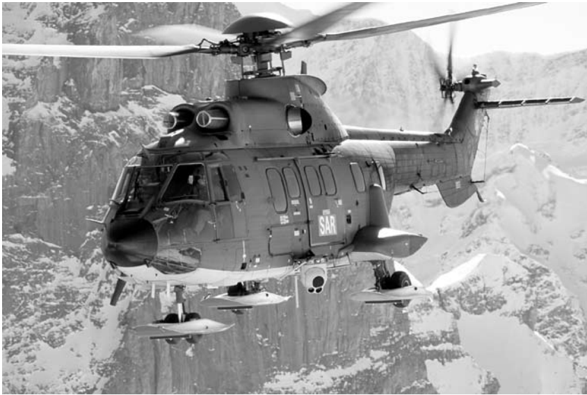
Der FLIR-Puma: Dank des kugelförmigen IR-Sensors hat sich das System bei Rettungseinsätzen bewährt.
