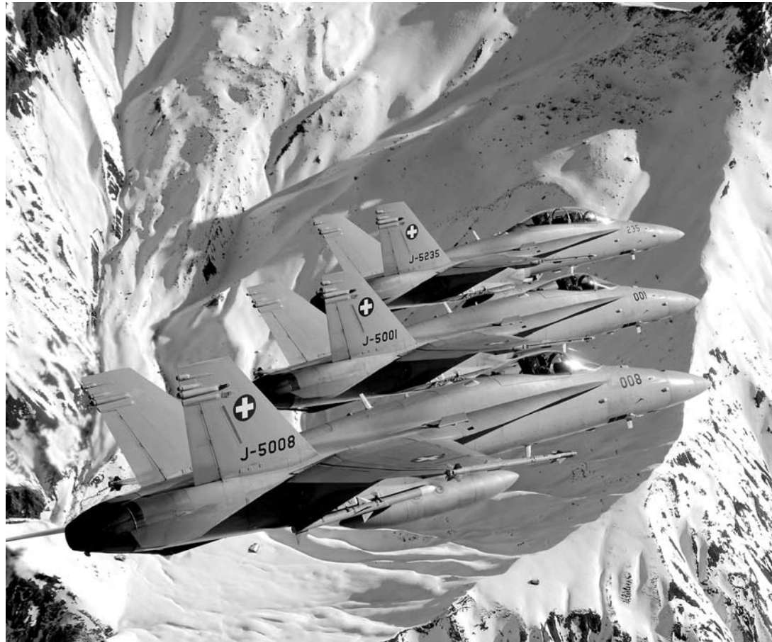
Die ersten drei modifizierten F/A-18 beim gemeinsamen Training. An der vordersten Maschine ist eine der neuen AIM-9X Manipulierlenk Waffen zu erkennen..
