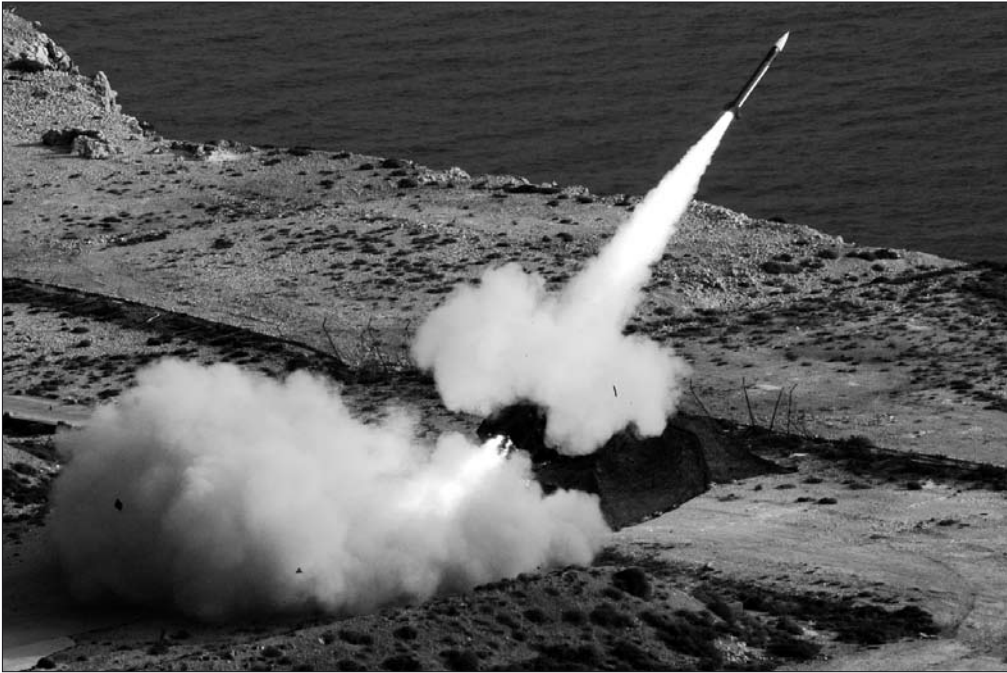
Der Abschuss einer PATRIOT Lenkwaffe. Der zuerst sehr steile Wegflug wird später flacher und trifft ca. 60km entfernt, außerhalb der Sichtweite, die Zieldrohne.
