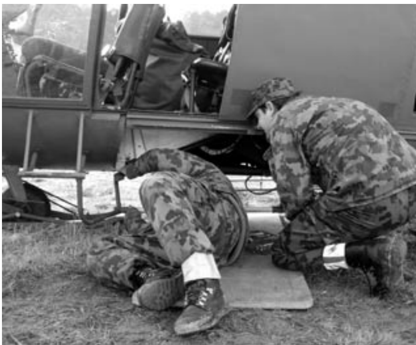
Zwei Helikoptermechaniker kontrollieren die Zellstruktur.
