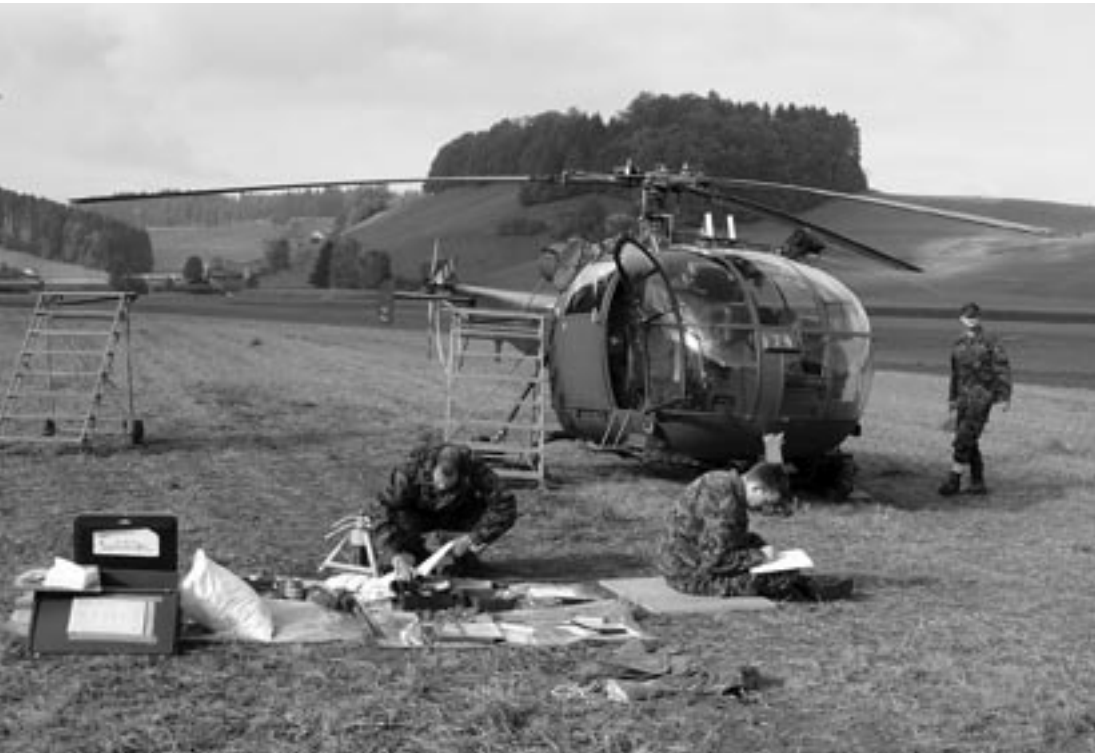
Kpl Landolt und seine Mechaniker bereiten einen Rotorblatt-Wechsel an einer Alouette 3 vor.
