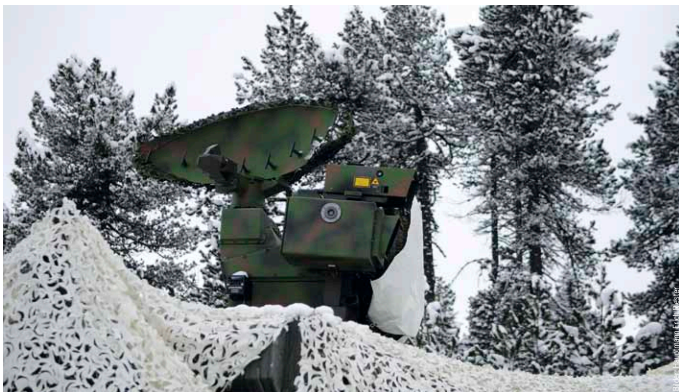
Das kampfwertgesteigerte Feuerleitgerät ist über eine Datenleitung mit der Einsatzzentrale der Luftwaffe verbunden.
