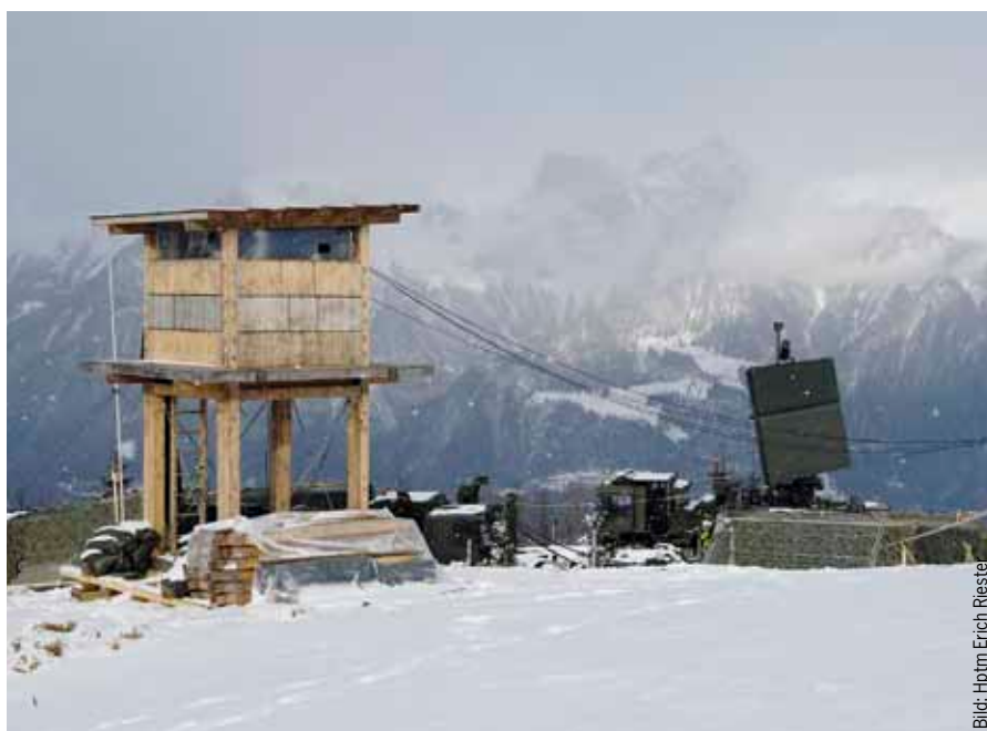
Eine mobile TAFLIR-Radaranlage erfasst Flugbewegungen im unteren Luftraum und ergänzt damit die Daten der Höhenanlagen.
