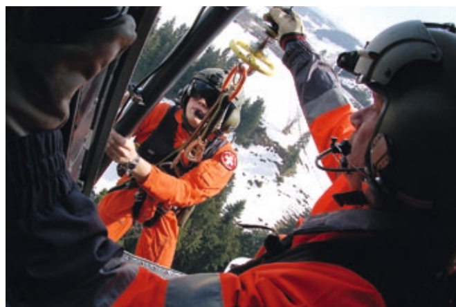
Der Helikopter ist mit einer Rettungswinde ausgerüstet.
