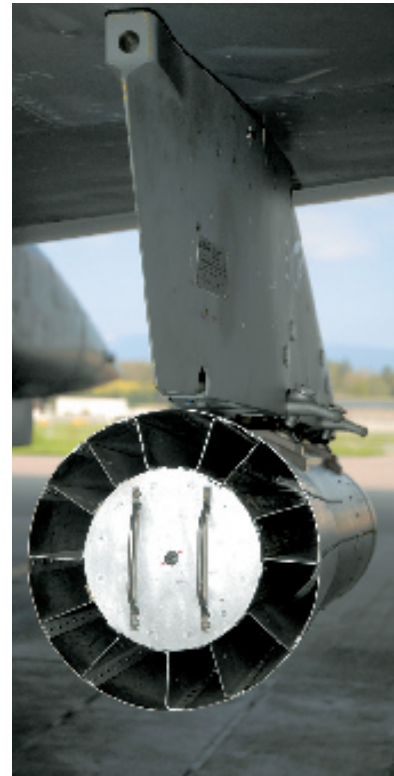
Ein Höhenluftfilter an der Flügelstation.
