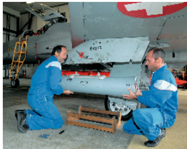
Oberst Thierry Goetschmann im Cockpit des EKUR-Tigers. Nach der Landung werden die kompletten Filtersysteme demontiert.
