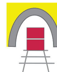
Aangepaste tunnel geschikt voor double stack
