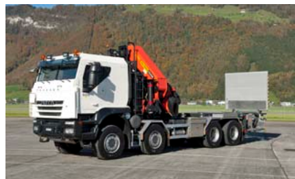
Geschützter Lastwagen, 8x8, mit Ladekran
