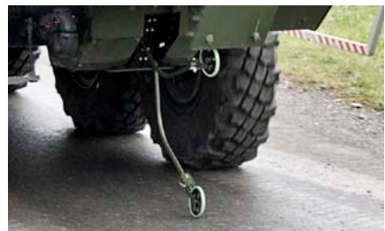
Kampfstoff-Detektion während der Fahrt
