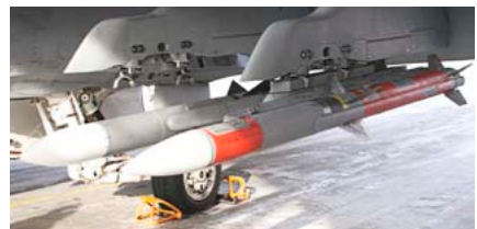
2 Luft-Luft-Lenk Waffen AMRAAM AIM-120C-7 an einem Doppelwerfer
