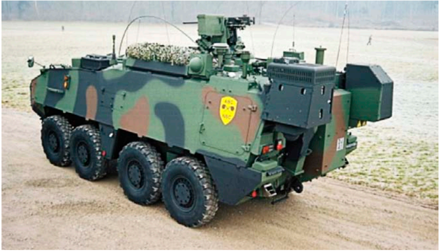
ABC-Aufklärungsfahrzeug auf Basisfahrzeug PIRANHA III C
