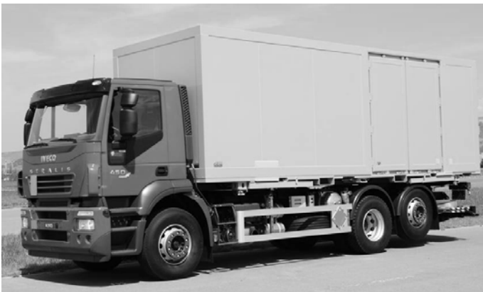
Lastwagen, 6×2, mit Kastenaufbau für Explosivstoffe
