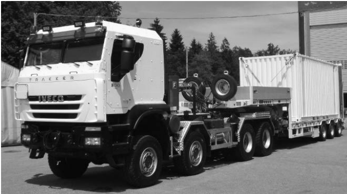
Geschützter Lastwagen am Beispiel IVECO, 8×8 (beim Einsatz als Sattelschlepper)
