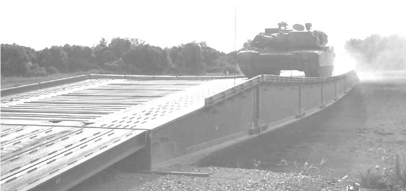
Unterstützungsbrücke 45 m im Einsatz
