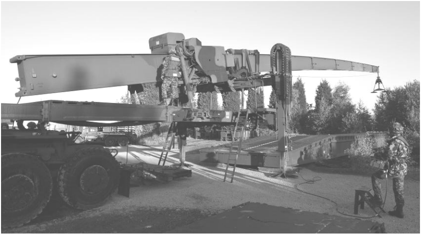
Verlegeeinheit in Arbeitsstellung
