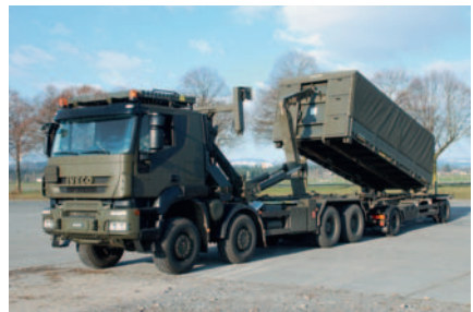
Lastwagen, 8x8, mit Wechselladesystem und Wechselaufbauanhänger mit Schlitten
